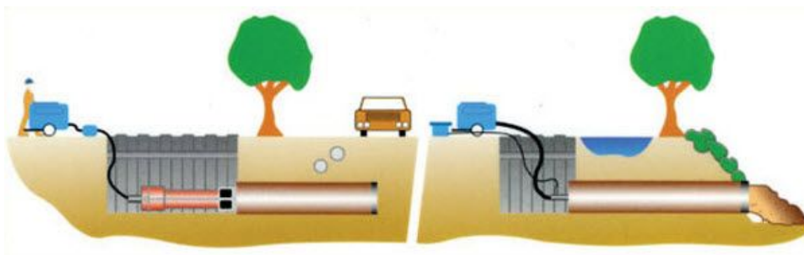
Esquema del método de hincada neumática de tubo de acero.
